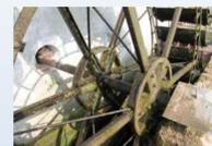
La paratoia di macchina della ruota (paratoia inclinata regolabile tramite volantino e cremagliera) è stata totalmente recuperata e ripristinata in ogni sua parte.
